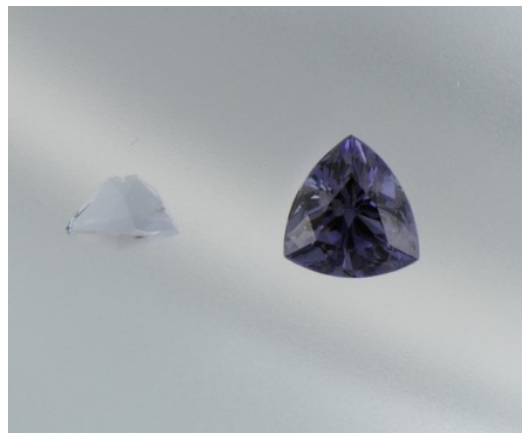
図 10-2 一部切断したもの(左)と再研磨したもの(右)
