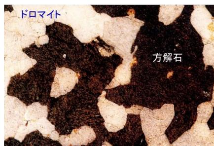
\*1: 次の①, ②の順序で、それぞれの水溶液に薄片を浸す。その結果、方解石が褐色に染色される。
