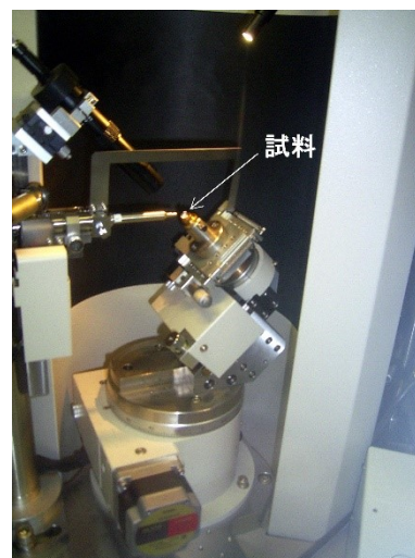
図6-6 微小領域X線回折装置 (右) と試料 (上), 試料のX線回折パターン (下)
