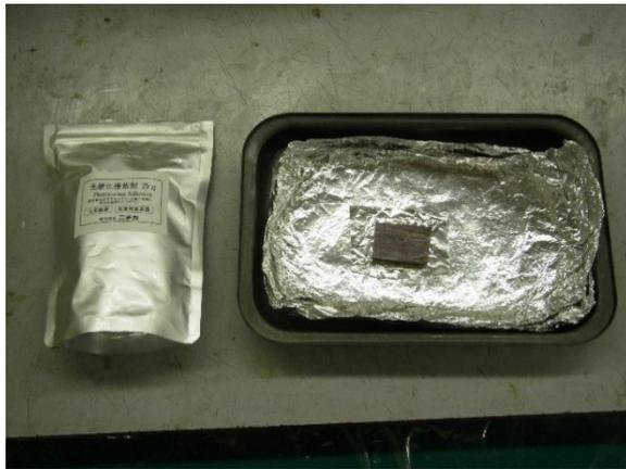
図16—1 1：袋に入っている光硬化型接着剤（左図）と接着する試料（右図）
