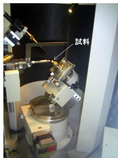
試料を微小領域X線回折装置にセットして得られたX線回折パターン (図6-6) からダイヤモンドだと同定できました。
