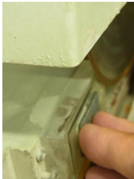
図16-14：スライドガラスに貼り付けた試料の厚さを2～3mmまで薄くする
