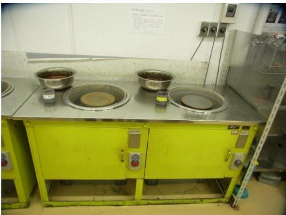
図16—4（左）：2連式のグラインダー。使用する研磨材は左右で変える（左：#800，右：#400）。電源スイッチは手を使わずに膝で押せるようになっている
