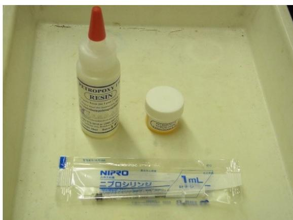
図16-8：ペトロポキシ（商品名）は主剤（上図左）と硬化剤（上図右）を10：1で混合させる。シリンジ（下図）を使って正確に測る。
