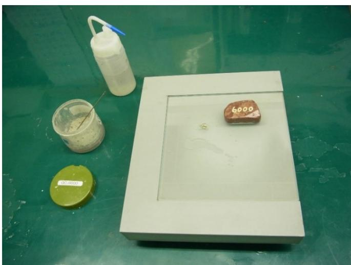
図16-7：ガラス板をセットした台。研磨材、水、均し石などを用意する。準備は研磨材の番号の大きいもの（細粒）から行う。後片付けも同じ順序で行う。
