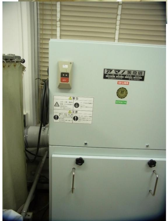
図16-3：岩石切断機（図左）には集塵機（図右）が取り付けられている
