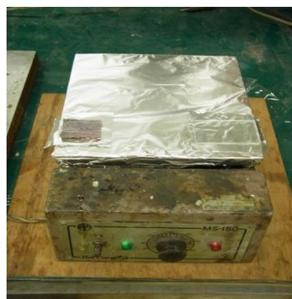
図16-9：ホットプレートにはアルミホイルを敷く。試料とスライドガラスも小さく切ったアルミホイルを下に敷く。
