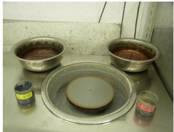
図16—5：回転盤の傍らには水と研磨材が入った容器（左：#400，右：#150）。研磨材を変える時は手や回転盤をよく洗う。水の容器も必ず変える。
